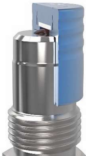
Durch ein Referenznormal, das auf die Messoptik aufgesteckt wird, lässt sich der Rückstreuungssensor Exspect 271 im Feld überprüfen und justieren
