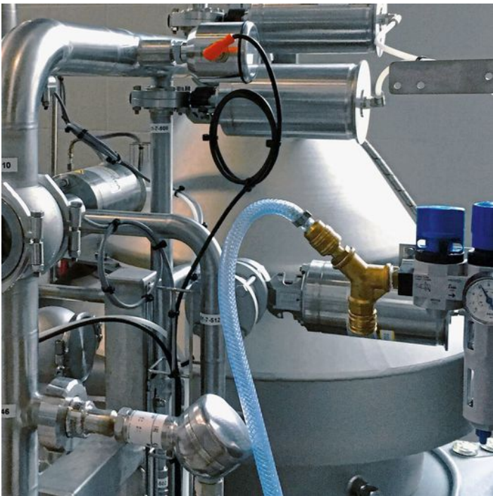
Exspect Trübungssensor im Ablauf eines Separators in einer Brauerei.
